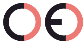
Marcatura CE contraffatta (troppo distante)
